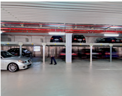
01 | D Während der Fahrer zu seinem Fahrzeug zurückgeht, werden die Stellplätze 109, 111 und 113 automatisch nach rechts verschoben und 115 in die gewünschte Zielposition gebracht.
